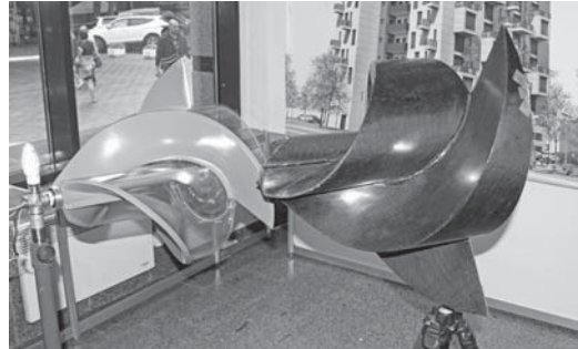
Ротор Оніпка – вітрова установка для перетворення вітру в електроенергію. Ця розробка отримала найвищу нагороду – «Зелений оскар» у Німеччині
