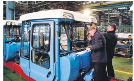
Процес монтажу кабіни для трактора (ХТЗ)
